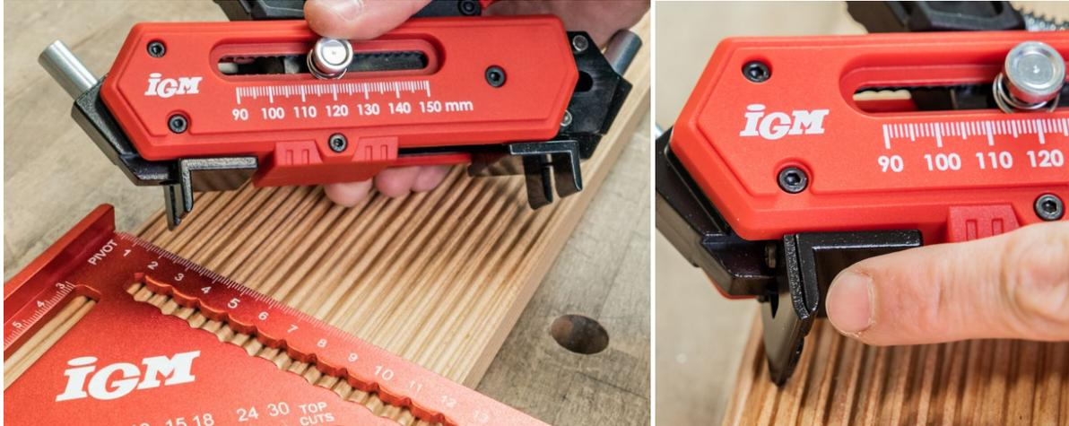
Spannen Sie die Vorrichtung durch Drücken des Griffs auf dem Brett ein. Setzen Sie die Schrauben in beide Buchsen ein.
