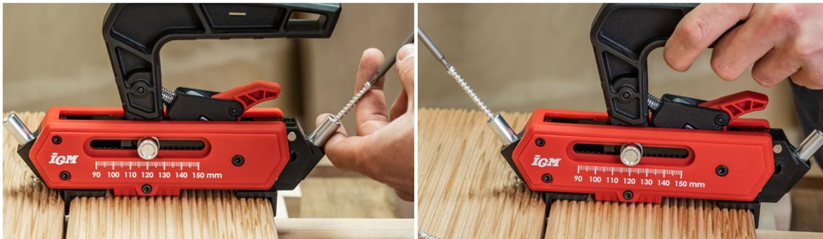
Klemmen Sie den Torx-Bit in den Bohrer und drehen Sie die Schrauben in das Material, bis der verlängerte Teil des Bits das Gehäuse berührt.
